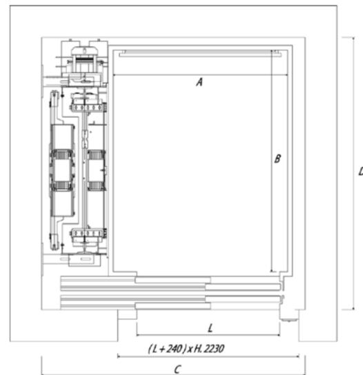
Tutte le configurazioni sono disponibili con meccaniche laterali o di fondo e con 1 accesso, 2 accessi opposti, 2 accessi adiacenti, 3 accessi, sia con vano in muratura sia con vano in incastellatura metallica
