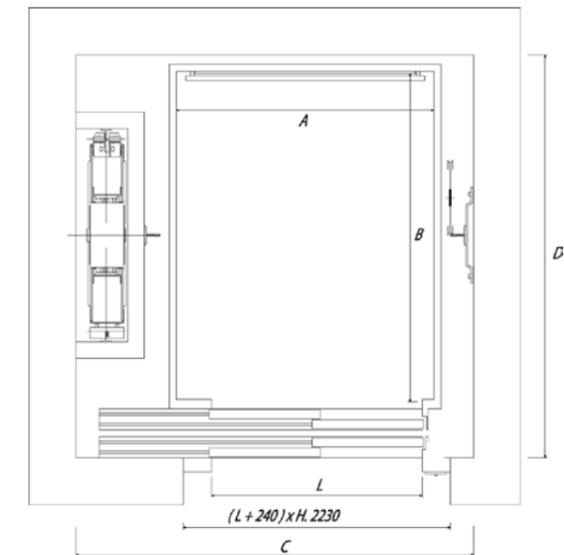
Tutte le configurazioni sono disponibili con 1 accesso, 2 accessi opposti, sia con vano in muratura sia con vano in incastellatura metallica
